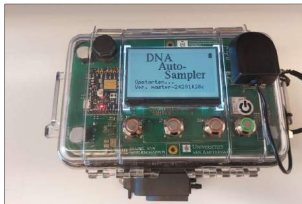
Abbildung 9: der DNA-Auto-Sampler zur automatisierten Entnahme von Wasserproben.
