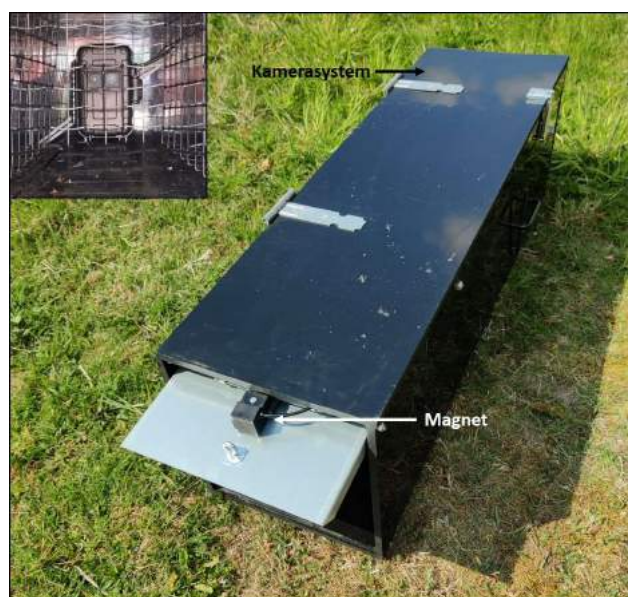
Abbildung 15: Aufbau des Prototyps einer selektiven Lebendfalle mit Magnet an der Fallenklappe und einem Bilderkennungs-system mit Kamera im Hinterraum der Falle. Das eingeschobene Foto zeigt das Bilderkennungs-system in der Falle.
