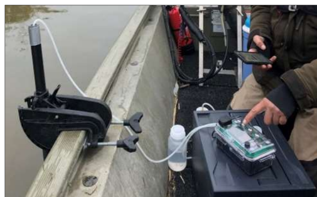
Abbildung 10: der DNA-Auto-Sampler im Einsatz vom Boot aus. Die Wasserproben werden über einen Schlauch gezogen und in einer Plastikflasche gesammelt.
