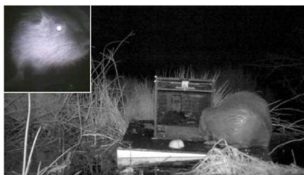
Abbildung 17: Eine Nutria betritt die selektive Lebendfalle. Das eingeschobene Foto zeigt die Aufnahme der Kamera in der Falle. Das Bild wird unmittelbar von einem Algorithmus analysiert und klassifiziert.
