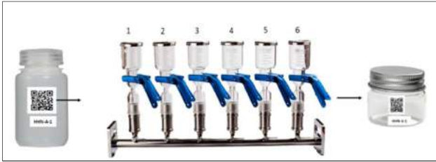
Abbildung 11: Schema der Verarbeitung der Wasserproben. Das Wasser aus der Plastikflasche wird gefiltert und anschließend wird das Filterpapier, das die eDNA enthält, weiterverarbeitet.
