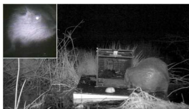
Figuur 17: Een beverrat gaat de slimme levend vangende kooi binnen. De ingevoegde foto toont een foto die van het dier is gemaakt door de camera in de kooi. Het beeld wordt direct geanalyseerd en geïdentificeerd door het algoritme.
