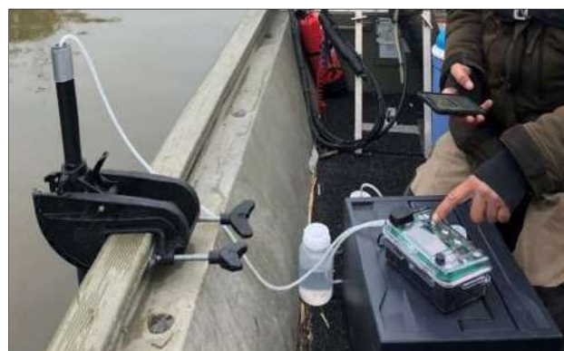
Figuur 10: Watermonsternamen via eDNA autosampler vanaf een boot. De watermonsters lopen door een plastic slang en worden opgevangen in een plastic fles.
