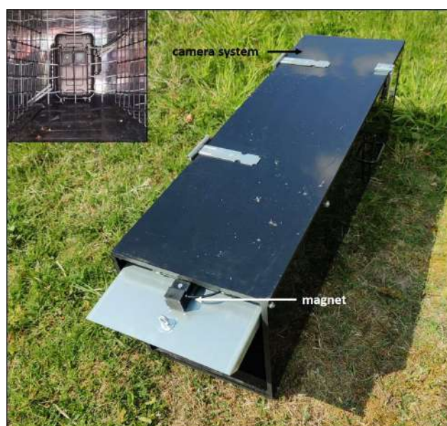
Figuur 15: De slimme levend vangende kooi met elektromagneet aan de klep en beeldherkenningsysteem in het achterste deel van de val. Ingevoegde afbeelding: beeldherkenningsysteem in de kooi.
