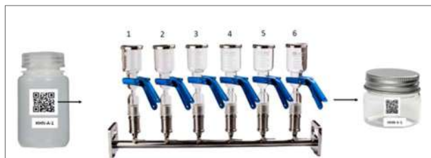
Figuur 11: Verwerking van de watermonsters. Het water uit de plastic fles wordt gefilterd en het filtreerpapier met daarin het eDNA wordt verder bewerkt.
