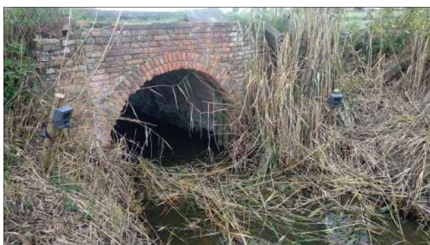
Figuur 3: Installatie van cameravallen bij een vaarweg. De camera's zijn gericht op het wateroppervlak.
