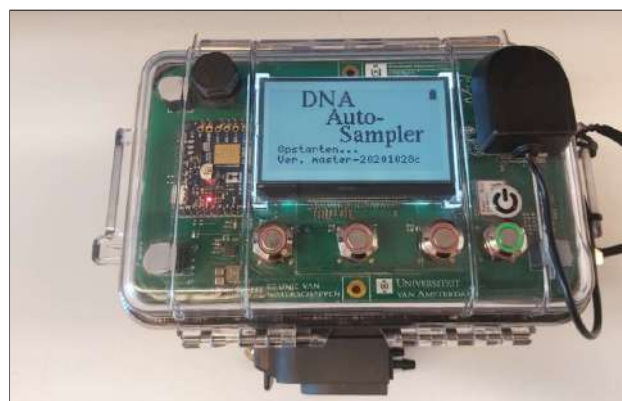
Figuur 9: eDNA autosampler voor geautomatiseerde watermonsternamen.
