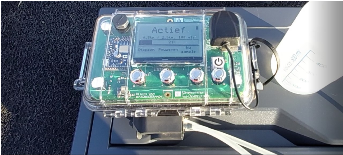
Figuur 12 De eDNA autosampler
